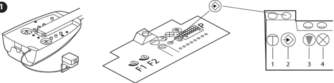
Repérer la touche
